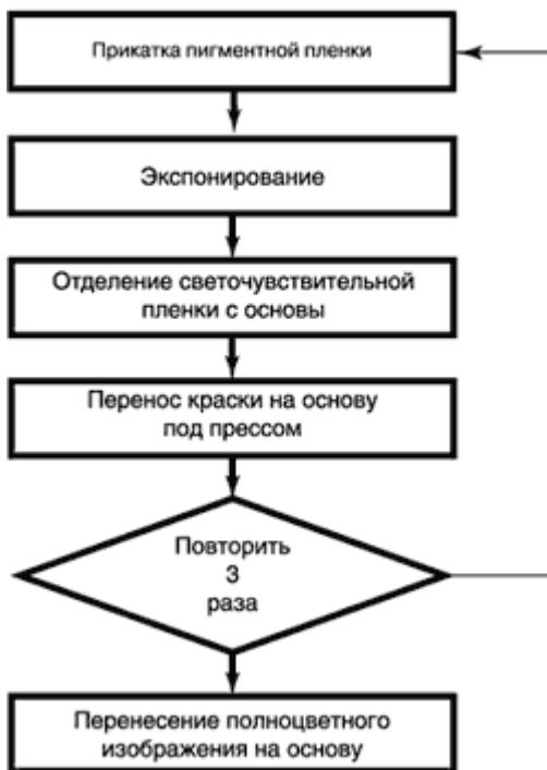
рис. 11. Блок-схема процесса получения цветопробного оттиска в устройстве Chromalin StudioSprint
