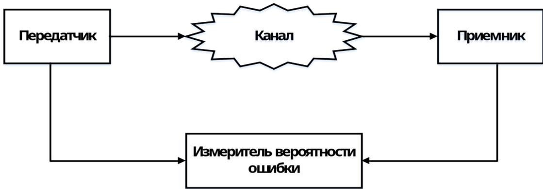
Рисунок 13 - Модель ЦНТВ с измерителем вероятности ошибок
