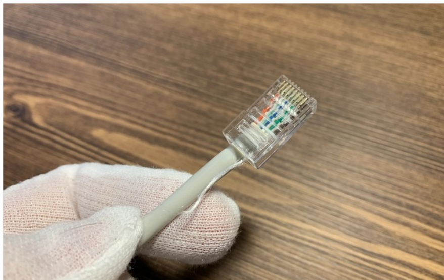
Рис.5 Установка жил в коннектор RJ-45
