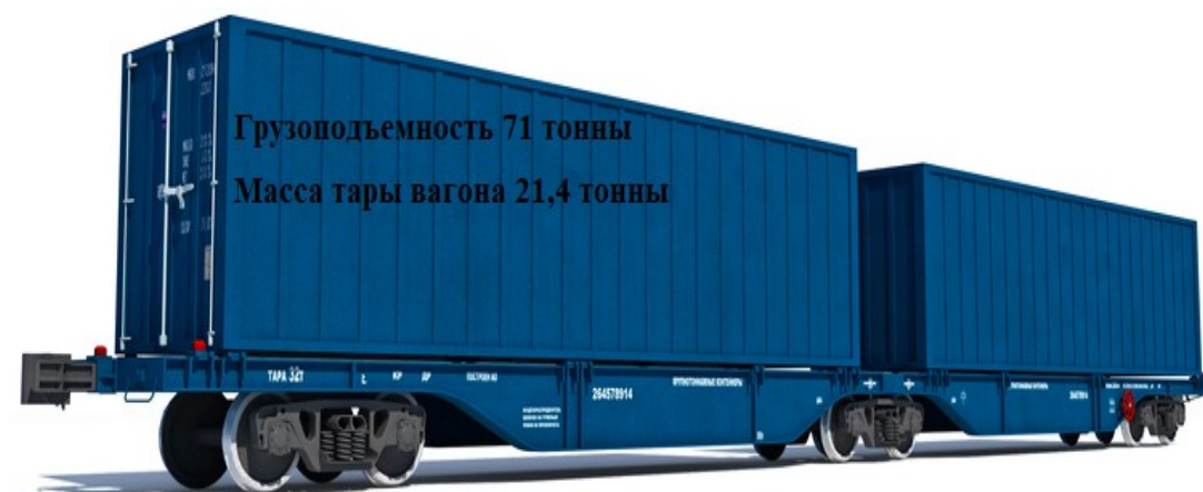
Сурет 2.1 - Екі 40 футтық контейнері бар 80 футтық фитингтік платформа
