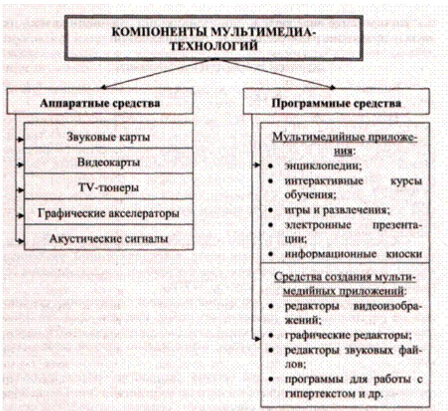
*Аппаратные средства* мультимедиа включают аналого-цифровые и цифроаналоговые преобразователи для перевода аналоговых аудио- и видеосигналов в цифровой эквивалент и обратно, видеопроцессоры для преобразования обычных телевизионных сигналов к виду, воспроизводимому электронно-лучевой трубкой дисплея, декодеры для взаимного преобразования телевизионных стандартов, специальные интегральные схемы для сжатия данных в файлы допустимых размеров и т.д.
