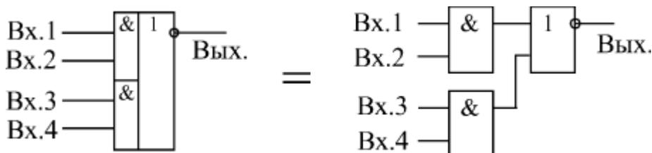
Рис. 1 Логический элемент ЛР1 и его эквивалентная схема
