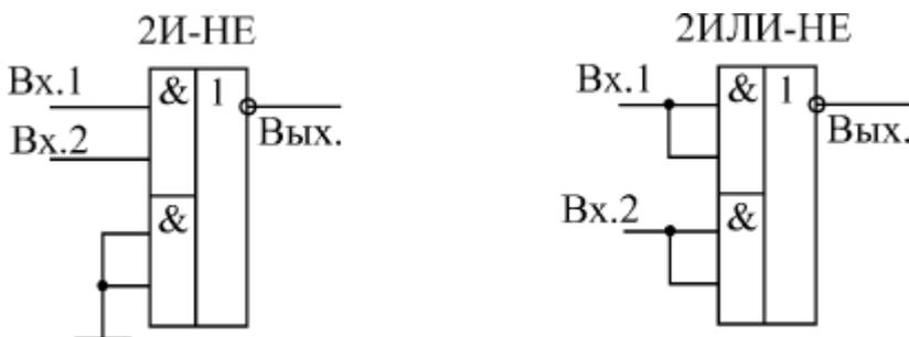
**Рис. 4** Использование элементов ЛР в качестве элементов 2И-НЕ и 2ИЛИ-НЕ
