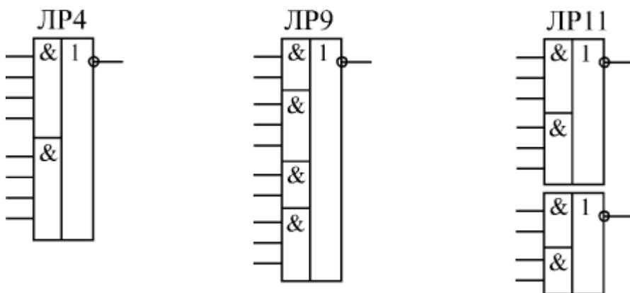
Рис. 2 Примеры логических элементов ЛР
