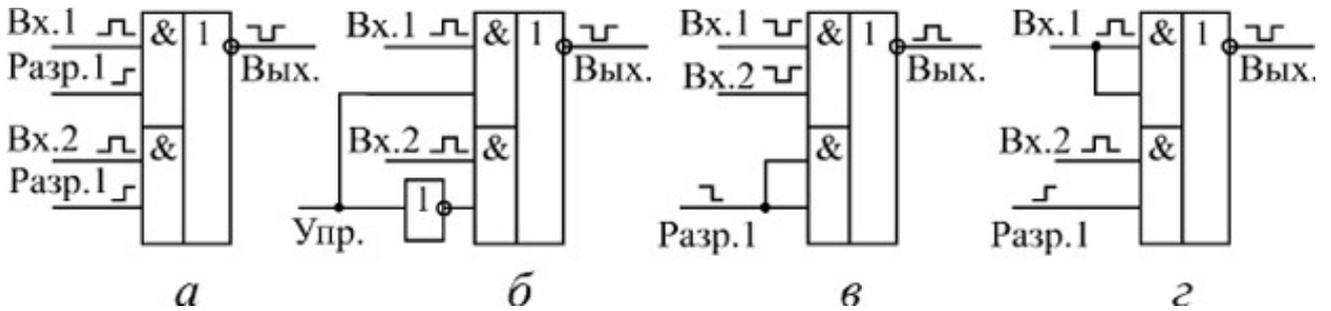
**Рис. 3** Примеры использования элементов ЛР1
