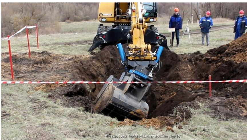
Ряд моделей экскаваторов, например UDS-114 (производства Чехословакии), оснащается устройством переворота ковша (ротатором), позволяющим оперативно переходить из режима прямой лопаты в режим обратной лопаты.
