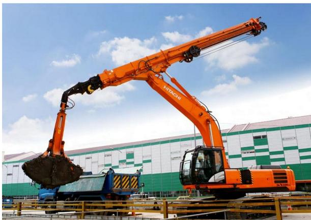
Грейфер используется для разработки узких глубоких котлованов (колодцев), выполнения погрузочно-разгрузочных работ. Грейферами могут оборудоваться как гидравлические, так и механические экскаваторы.
