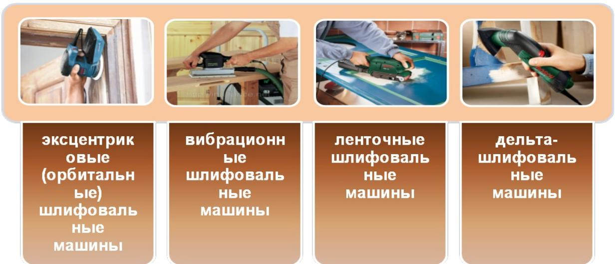
При помощи **эксцентрик**овых **шлифмаши**н можно обрабатывать разные материалы, поэтому шлифлисты к ним могут иметь различную зернистость.
