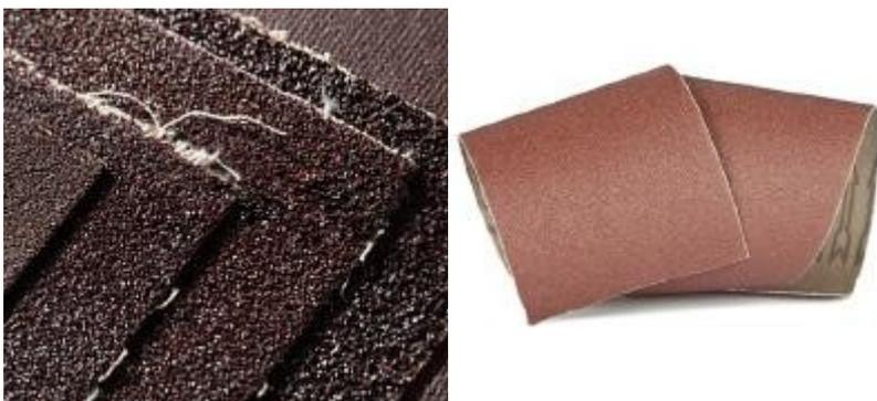
Остроугольные стеклянные зерна оставляют на древесине, особенно мягких пород, заметные следы, при поперечной шлифовке такая шкурка применяется только для грубых обдирочных работ, когда надо снять следы грязи, извести, старой краски.
