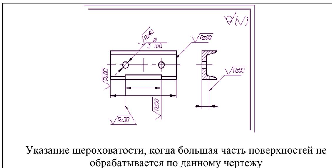
Обозначение шероховатости поверхностей повторяющихся элементов изделия (отверстий, пазов, зубьев и т. п.), количество которых указано на чертеже, а также обозначение шероховатости одной и той же поверхности наносят один раз, независимо от числа изображений.
