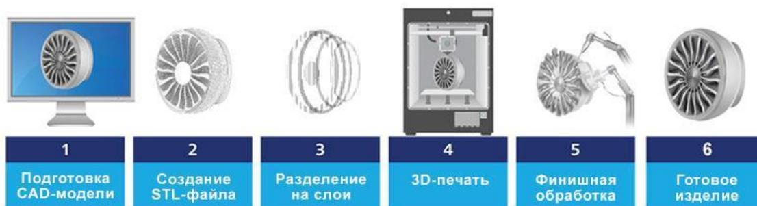
Рисунок 1 – Общая схема аддитивного производства<sup>202</sup>.
