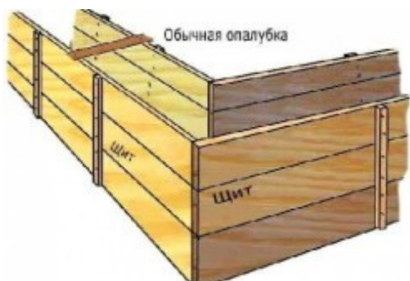
Схема обычной опалубки фундамента.
