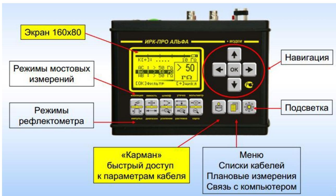
Рис.1 Внешний вид прибора ИРК-ПРО Альфа и функциональные клавиши
