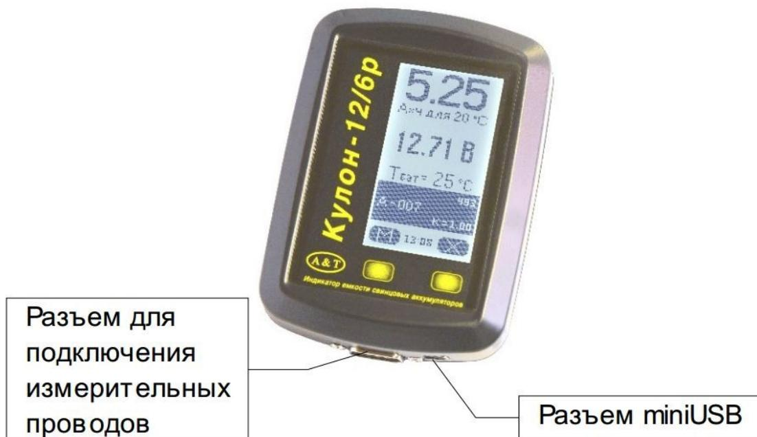
*Рис.3 Внешний вид прибора Кулон-12/6р*
