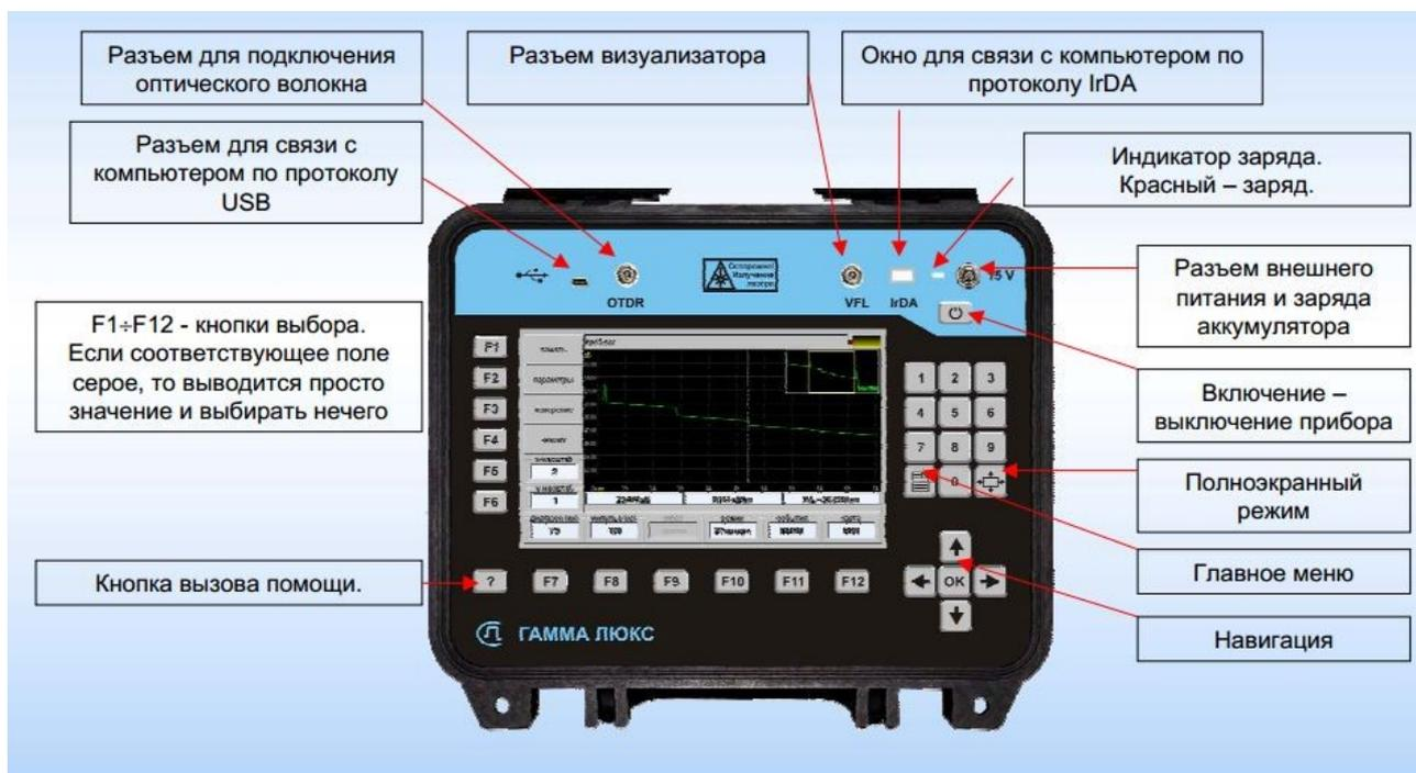
Рис.2 Внешний вид прибора ГАММА-ЛЮКС и органы управления
