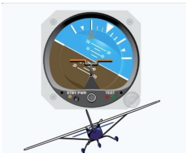
Рисунок 5. Авиагоризонт с прямой индикацией.
