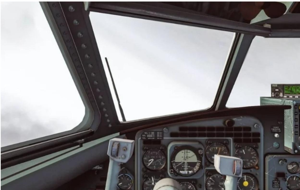
Рисунок 7. Отображение пространственного положения самолета на АГ ОИ при крене большем, чем 90.
