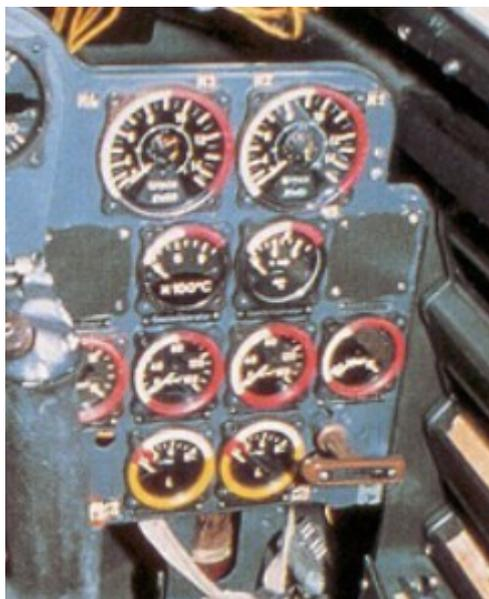
Рисунок 8. Цветовая индикация в самолете Messerschmitt Me.262.
