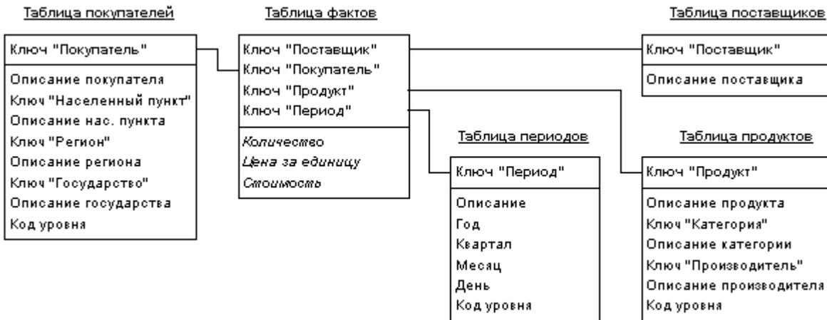
В сложных задачах с многоуровневыми измерениями имеет смысл обратиться к расширениям схемы звезды - схеме созвездия (fact constellation schema) и схеме снежинки (snowflake schema). В этих случаях отдельные таблицы фактов создаются для возможных сочетаний уровней обобщения различных измерений. Это позволяет добиться лучшей производительности, но часто приводит к избыточности данных и к значительным усложнениям в структуре базы данных, в которой оказывается огромное количество таблиц фактов.
