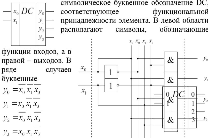
образом. Дешифраторы данной структуры относятся к классу линейных, так как все элементы, формирующие выходные сигналы оказываются как бы выстроенными в одну линию.
