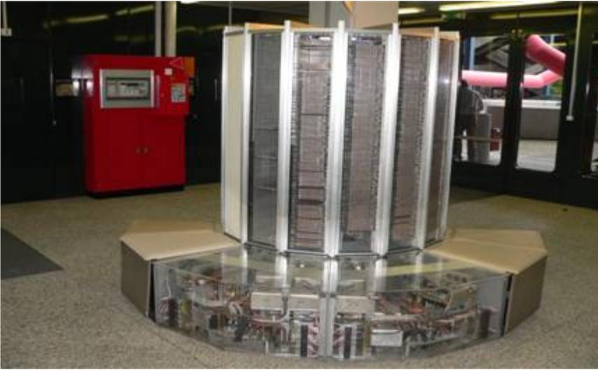
Cray-1, был самым быстродействующим на тот момент времени. Память Cray-1 составляла 8 Мбайт, поделенных на 16 блоков, с суммарным временем доступа 12,5 нс. Имелась и внешняя память на магнитных дисках емкостью около 450 Мбайт, расширявшаяся до 8 Гбайт. Для машины был создан оптимизирующий транслятор с Фортрана, макроассемблер и специальная многозадачная ОС.
