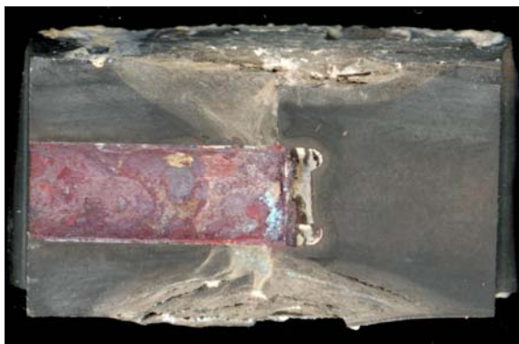
Рис. 192. Внешний вид продольного спила в районе трехфазной границы анода \text{SnO}_2+1.5\%\text{MnO}_2+1.5\%\text{Sb}_2\text{O}_3 после ресурсных испытаний в течение 17 ч.
