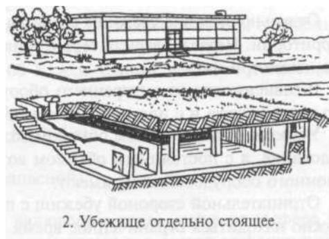
**Противорадиационное укрытие (ПРУ)** - это защитное сооружение, обеспечивающее защиту укрываемых от светового излучения, воздействия ударной волны малой мощности (до  $0,2 \text{ кг/см}^2$ ) и значительно ослабляющее воздействие проникающей радиации.
