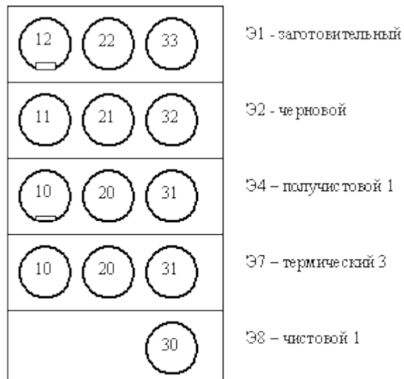
Рис.9.3. Распределение МОП по этапам принципиальной схемы для примера со «втулкой»
