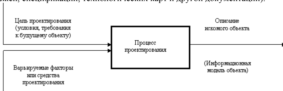
Рис.2.1. Процесс проектирования с информационной точки зрения.
