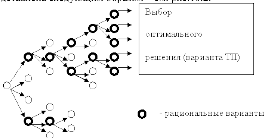
Рис.10.2. Общая модель процесса технологического проектирования с поэтапным отсечением решений на каждом уровне
