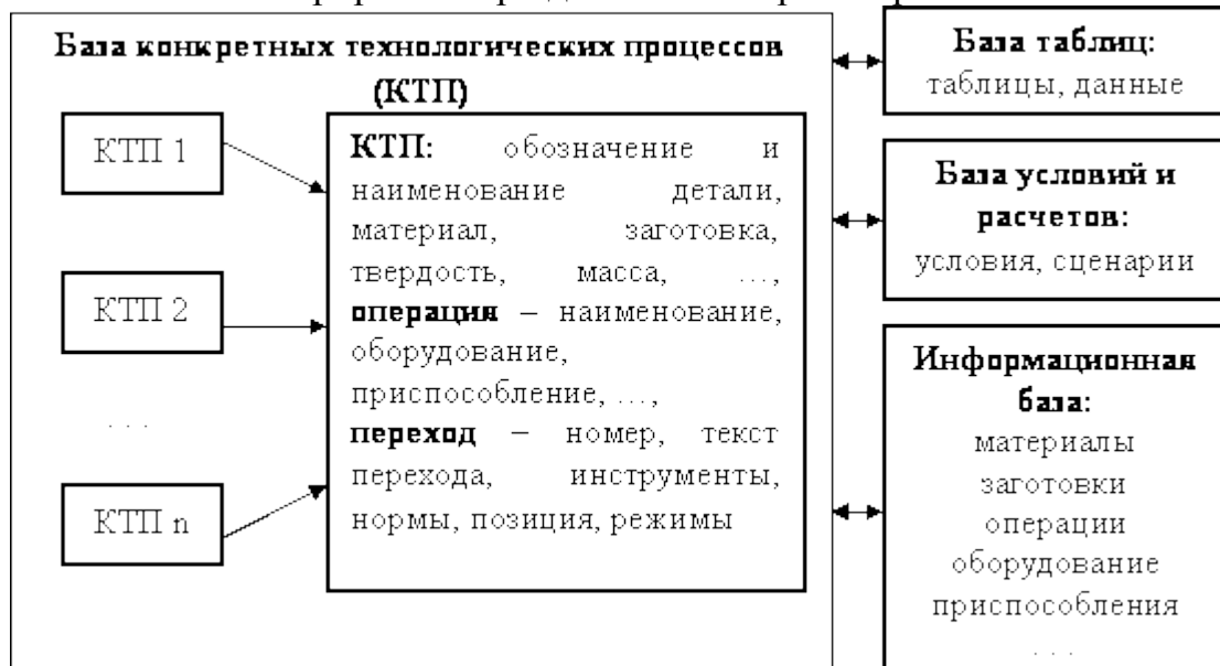
Рис. 15.1. Информация, используемая пользователем при диалоговом проектировании технологических процессов
