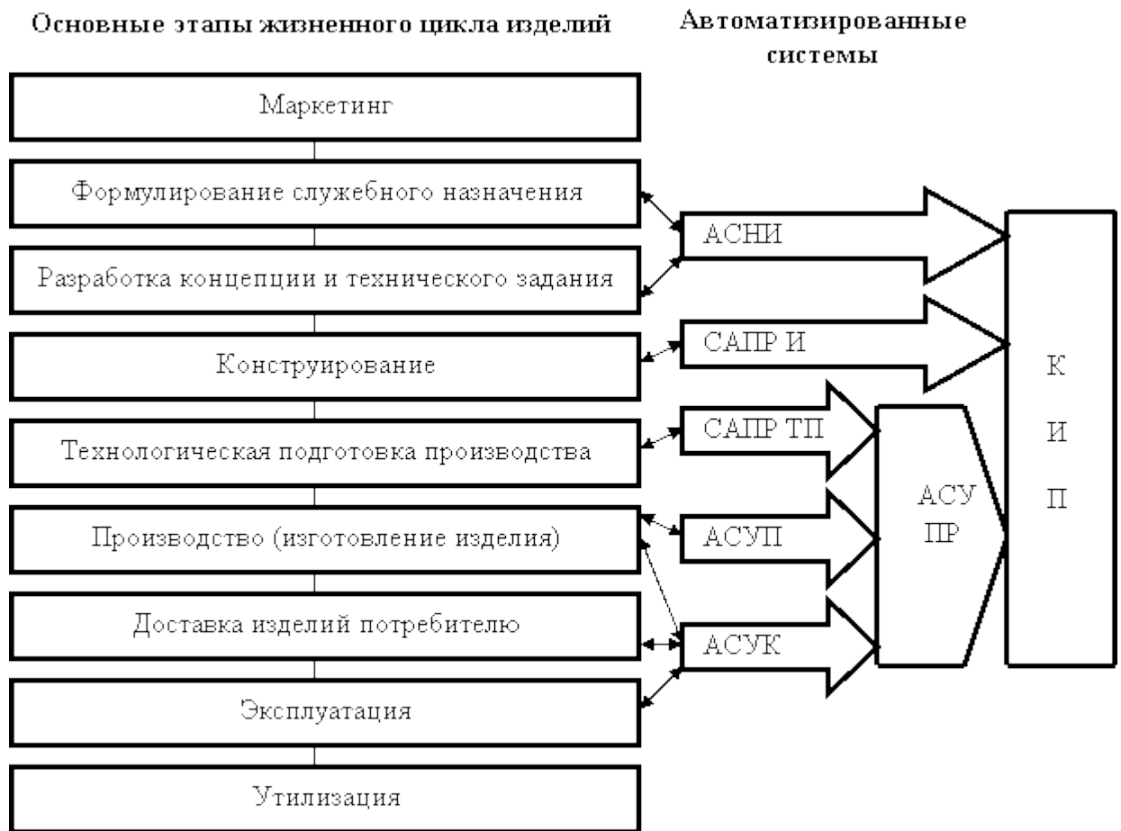
Рис.4.2. Основные системы компьютерно – интегрированного производства
