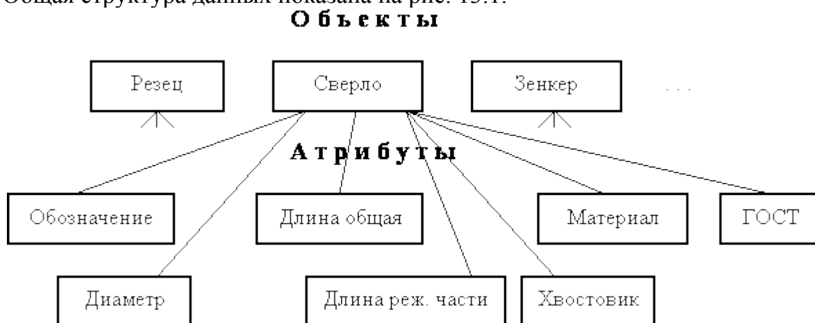
Рис.13.1. Общая структура данных БД «Режущие инструменты»
