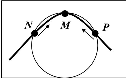
Центром и радиусом кривизны траектории в точке  $M$  называется центр и радиус кривизны окружности, соприкасающейся с траекторией в точке  $M$ . Очевидно, что в случае пространственной траектории соприкасающаяся окружность лежит в соприкасающейся плоскости. Прямолинейную траекторию можно считать траекторией с бесконечным радиусом кривизны.
