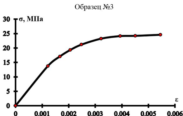
Рисунок 4 – Диаграмма деформирования образца №3
