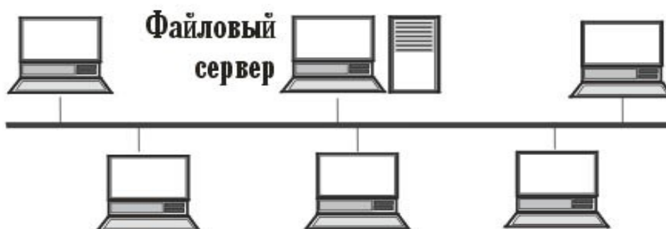
Рисунок 5. Схема шинной топологии.
