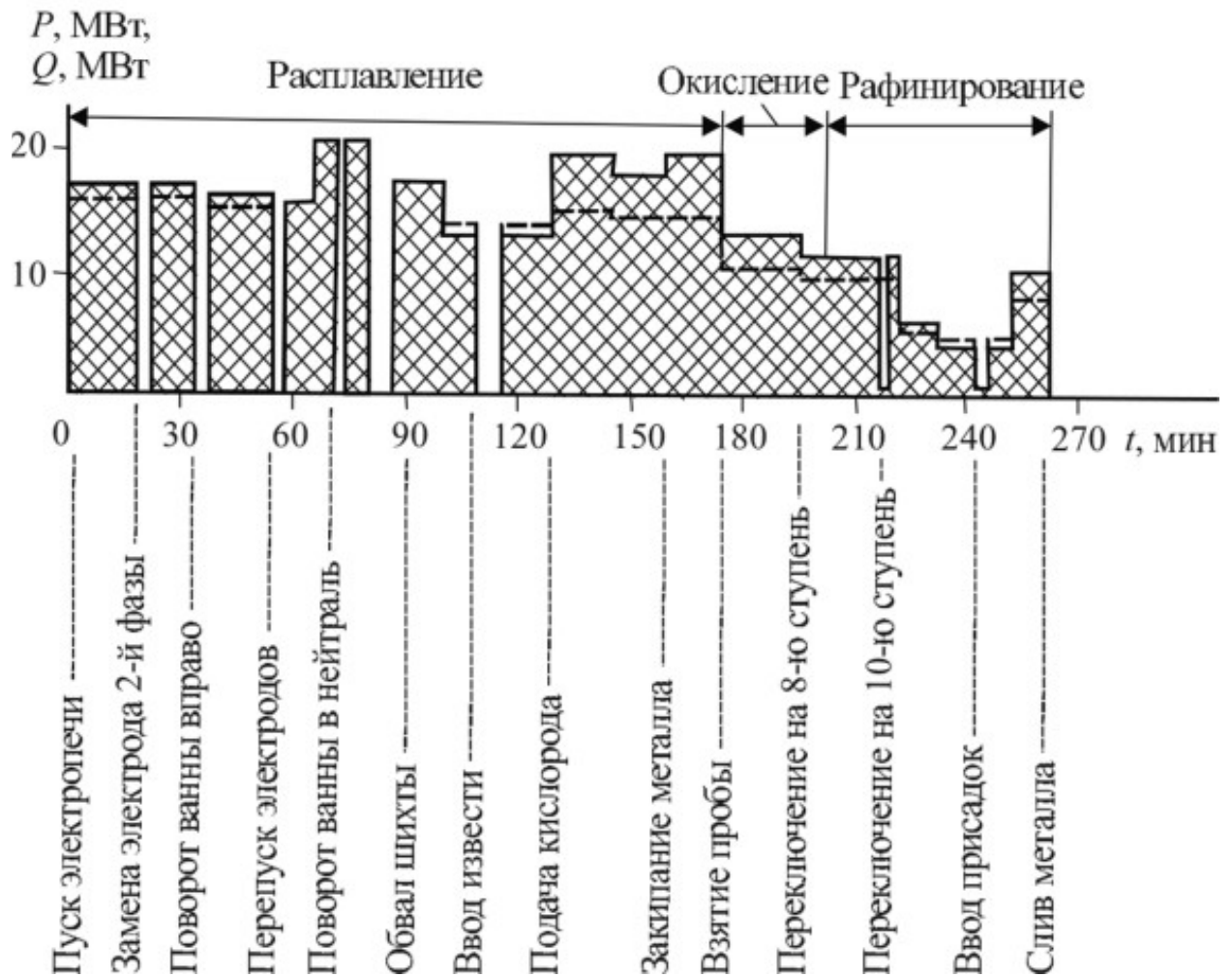
Рисунок 7.2 Циклический график нагрузки электрической печи
