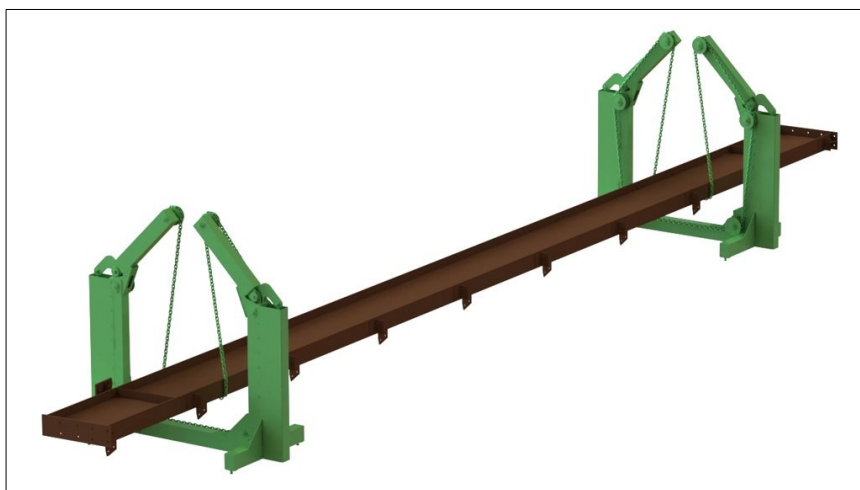
Рис.2.6. Кантователь сборно-сварочный КЦР-3.
