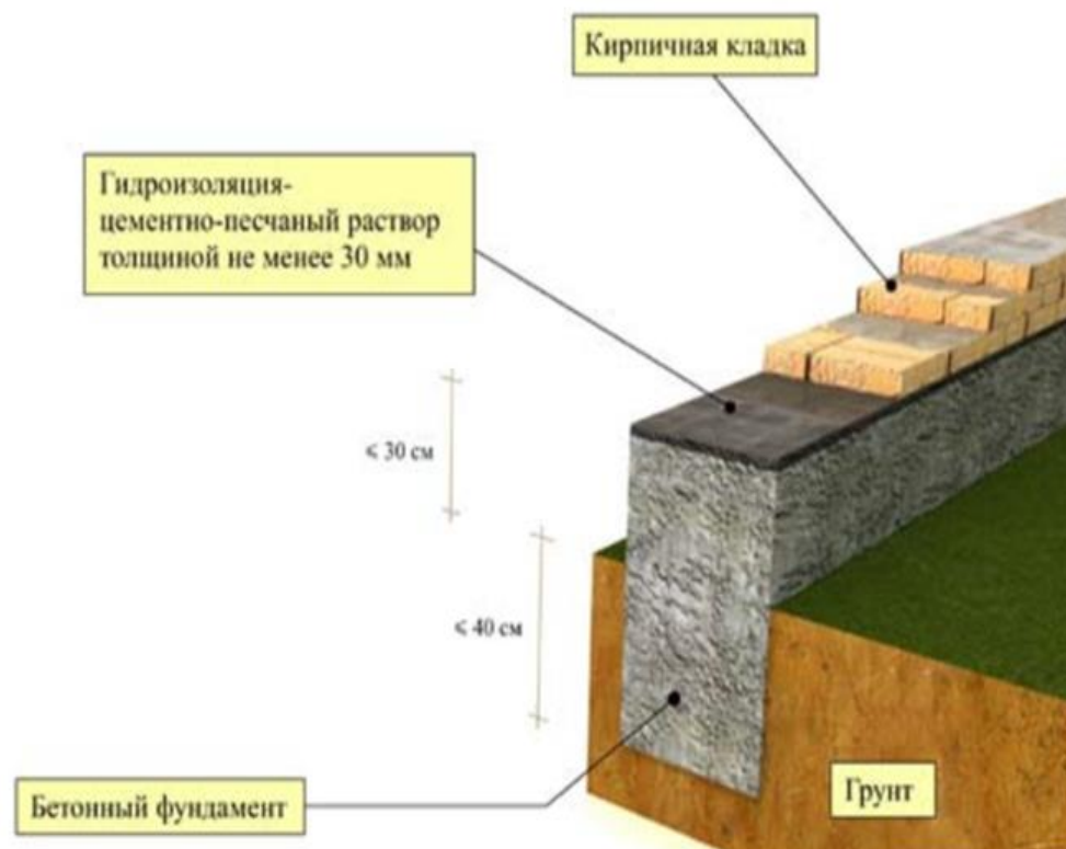
Рисунок 7. Ленточный бетонный фундамент
