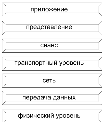
Рис.1. Семь уровней модели OSI для протоколов связи локальных сетей
