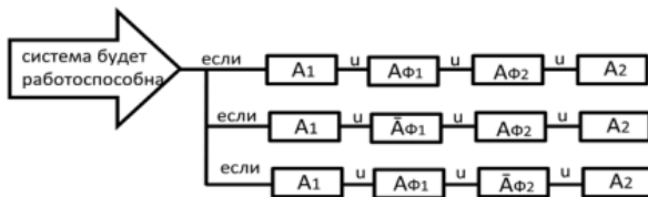
Рис. 1.12. Логическая схема надежности системы
