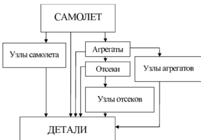
Рис. 1. Принципиальная схема деления в определенной последовательности планера самолета на части
