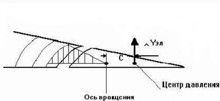
Рис. 6.3. Схема осевой компенсации элерона
