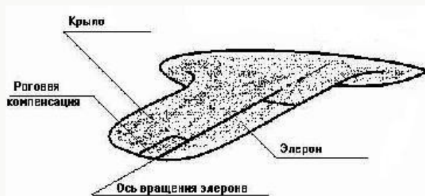
Рис. 6.4. Схема роговой компенсации элерона
