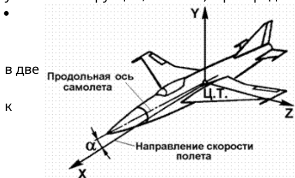
Рис. 2.1. Скоростные оси координат для самолета
