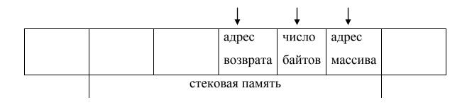
Для циклического обнуления байтов в массиве подпрограмма должна использовать два регистра — ЕСХ как счетчик цикла и ЕВХ в качестве хранилища адреса очередного байта массива (косвенная адресация). Поэтому при входе в подпрограмму значения этих регистров должны быть сохранены в стеке, а при завершении подпрограммы — восстановлены. Пролог в подпрограмме обнуления будет иметь следующий вид:
