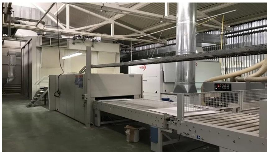
Рисунок 2 – Автоматическая линия крашения
