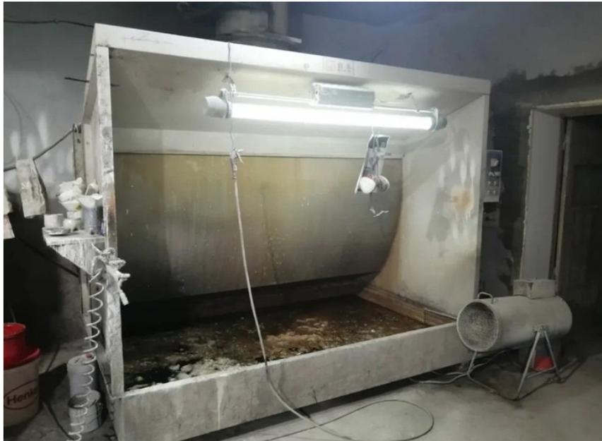
Рисунок 1 – Окрасочная камера с водяной завесой
