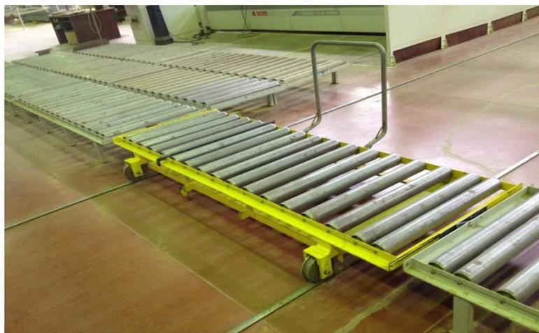
Рисунок 5 – Тележки для перемещения продукции
