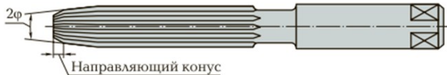
Рис. 3.18. Развертка для ручного развертывания: 2\varphi — угол заострения заборного конуса
