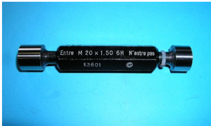
Гладкий калибр-пробка под резьбу M20x1,5 мм с полем допуска среднего диаметра 6H. Слева проходной, справа — непроходной.
