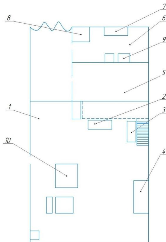
1 – аудитория 2120; 2 – токарно-винторезный 16К20; 3 – токарно-винторезный 1М61; 4 – муфельные печи; 5 – аудитория 2119; 6 – аудитория 2118; 7 – шлифовальный станок 3Г71; 8 – фрезерный станок 6Р81; 9 – сверлильный станок 2Г125; 10 – пресс
