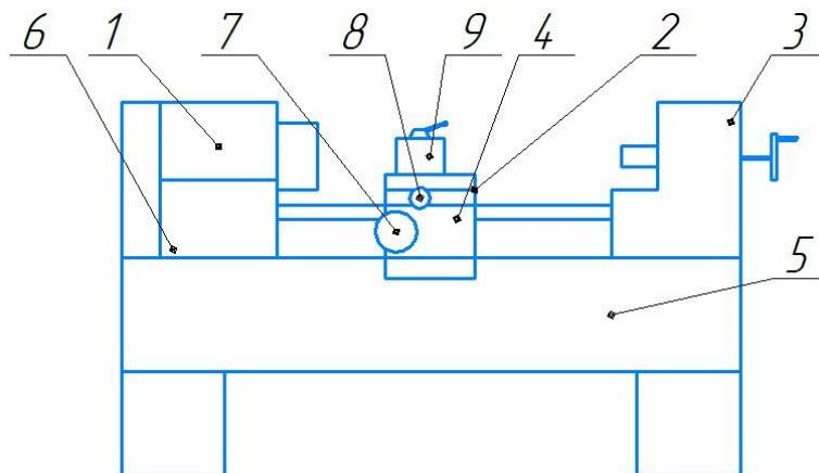
1 – передняя (шпиндельная) бабка; 2 – суппорт; 3 – задняя бабка; 4 – фартук; 5 – станина; 6 – коробка подач; 7 – маховик продольной подачи; 8 – маховик поперечной подачи; 9 – резцодержатель
