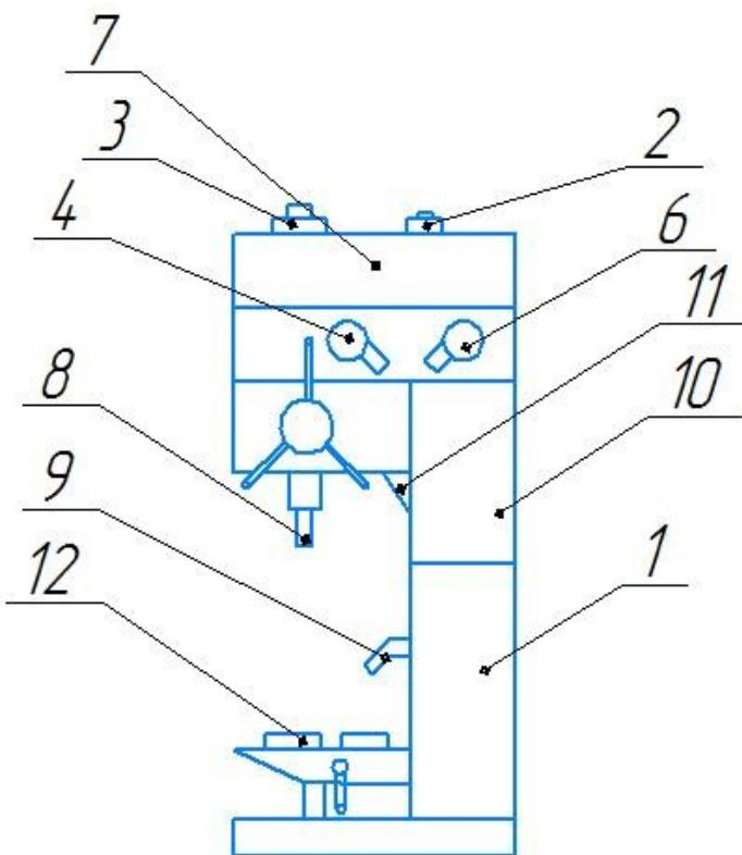
1 – колонна, плита, стол; 2 – привод; 3 – коробка скоростей и подач; 4 – механизм управления коробкой скоростей; 5 – Механизм управления вариатором; 6 – механизм управления коробкой подач; 7 – головка; 8 – шпиндель; 9 – охлаждение; 10 – электрооборудование ; 11 – светильник; 12 – тиски.
