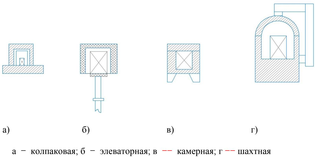
а – колпаковая; б – элеваторная; в – камерная; г – шахтная
