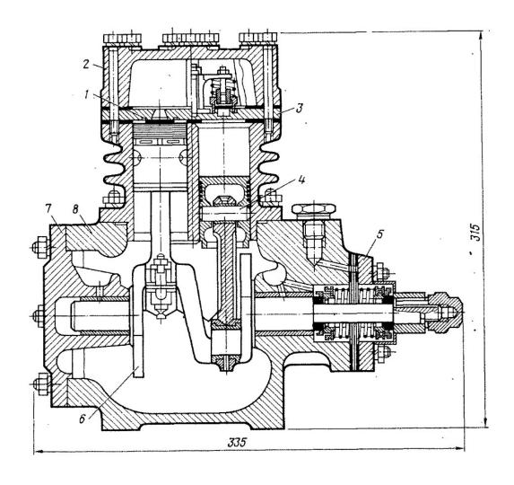
1 - клапан всасывающий; 2 - крышка; 3 - клапанная плита; 4 - поршень с шатуном; 5 — крышка сальника; 6 - вал коленчатый; 7 — опора вала; 8 — картер в сборе.
