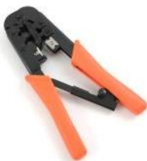
Рис. 5 Обжимное устройство TL-268/HT-568.
