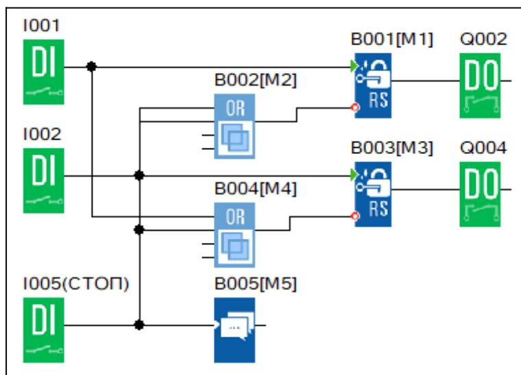
При нажатии на IN1сигнал поступает на установочный вход RS-триггера и включает его, приводя лампу Q2 в состояние логической единицы. Отключение триггера происходит либо нажатием кнопки IN2, либо по сигналу кнопки IN5 «СТОП». Для этого используем функцию «ИЛИ», на вход которого приходят оба сигнала и с выхода блока идут на выход сброса RS-триггера.
