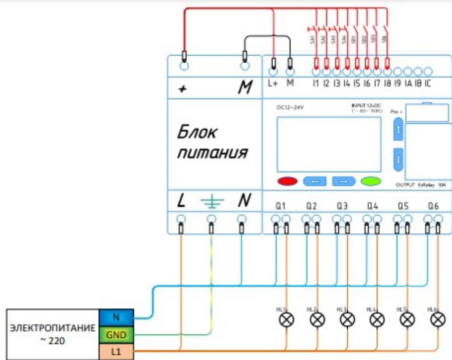
Для подключения кнопок используется входы с 11-18, остальные входы реле не подключены, напряжение цепи управления – 24 В. На всех выходах реле подключены индикаторные лампы AD22D2 на напряжение входной цепи – 220 В.
