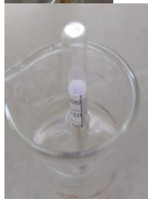
5. Измерить плотность полученного раствора при помощи ареометра. Для этого часть раствора ( $\approx 40 - 45$  мл) раствора перелить в мерный цилиндр на 50 мл и аккуратно поместить в раствор ареометр. Подождать пока ареометр не
