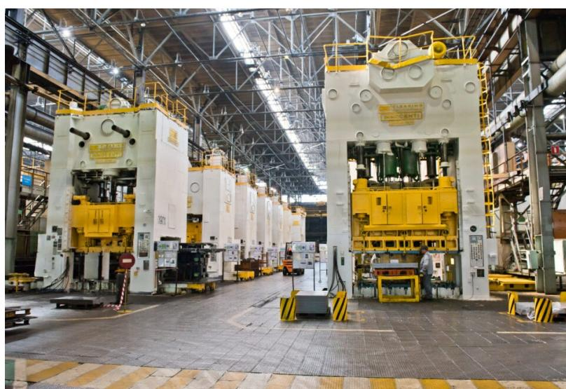
Рисунок 2 – Автоматическая линия штамповки АО «АвтоВАЗ»
