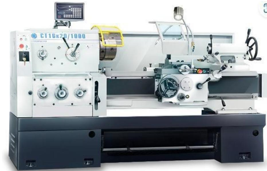
Рисунок 6 - Токарный станок 16К20
