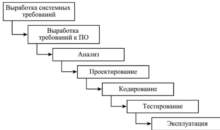
Рисунок 1 Каскадная модель жизненного цикла программного обеспечения
