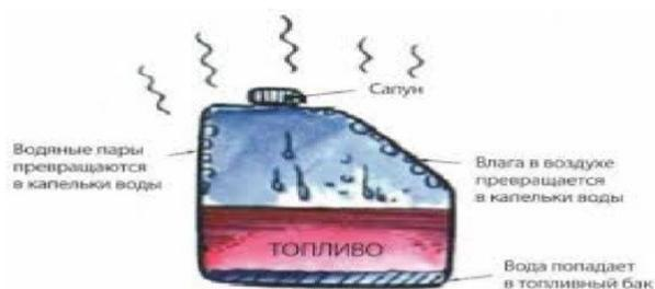
**Наличие воды в бензине отрицательно сказывается на работе двигателя, особенно авиационного. Неполадки усугубляются, если в топливной емкости вода и бензин расслаиваются, может наступить момент, когда в двигатель начнет поступать вода ...**
