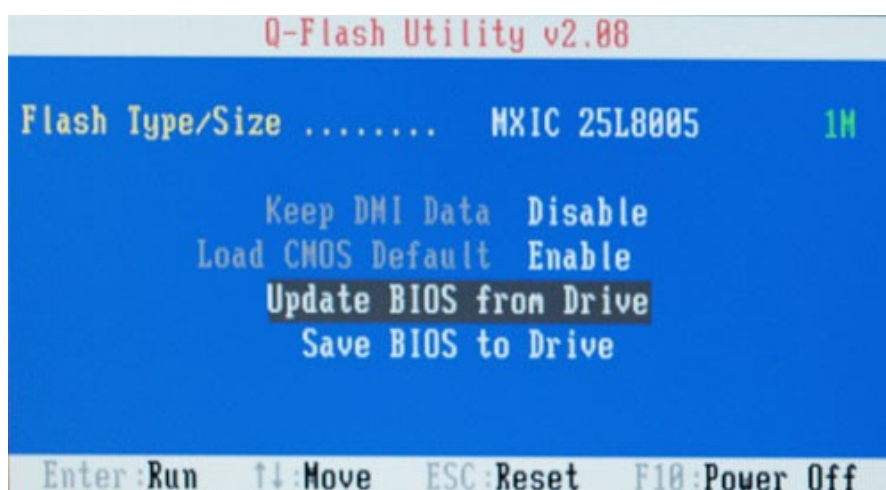
Рис. 14 Пример Q-Flash на BIOS системе
