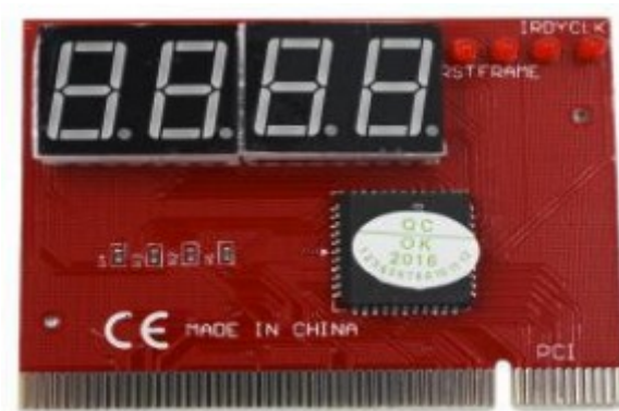
Рис. 12 POST-карта с PCI интерфейсом
