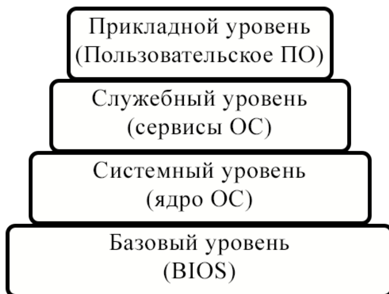
Рис. 3 Иерархия уровней в программном обеспечении ПК
