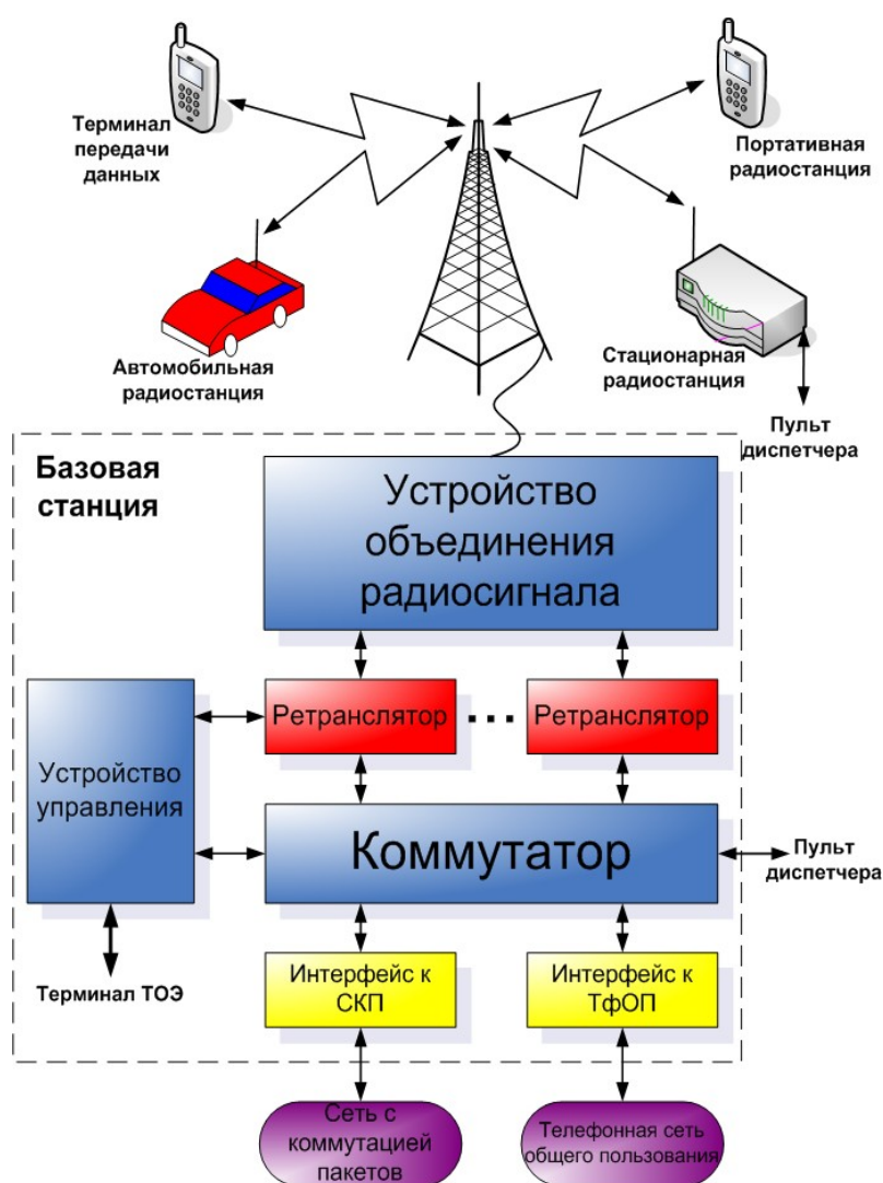
Рисунок 1 - Обобщенная структура однозоновой транкинговой системы.
