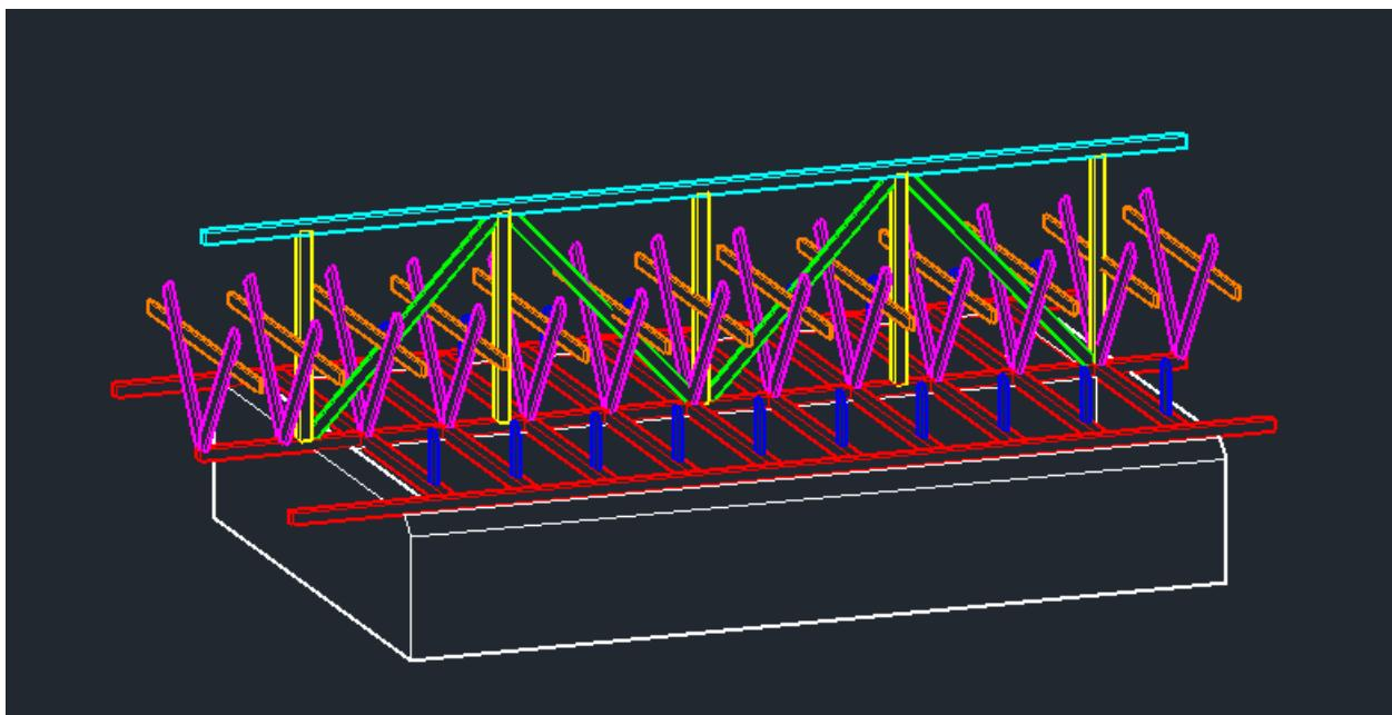
Рис.9. Создание затяжек и опорных стоек для стропильных ног
