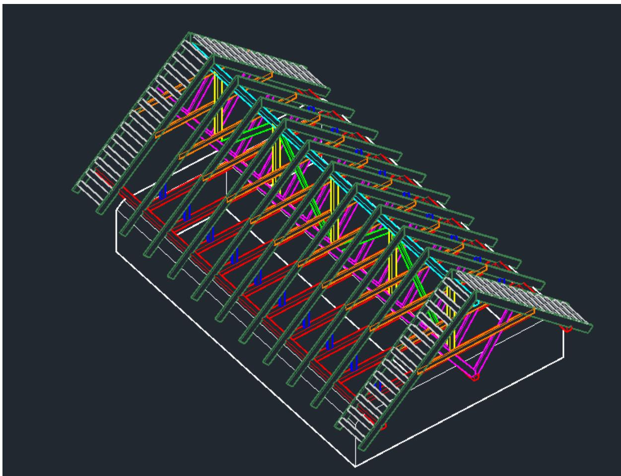
Рис. 10. Создание стропильных ног
