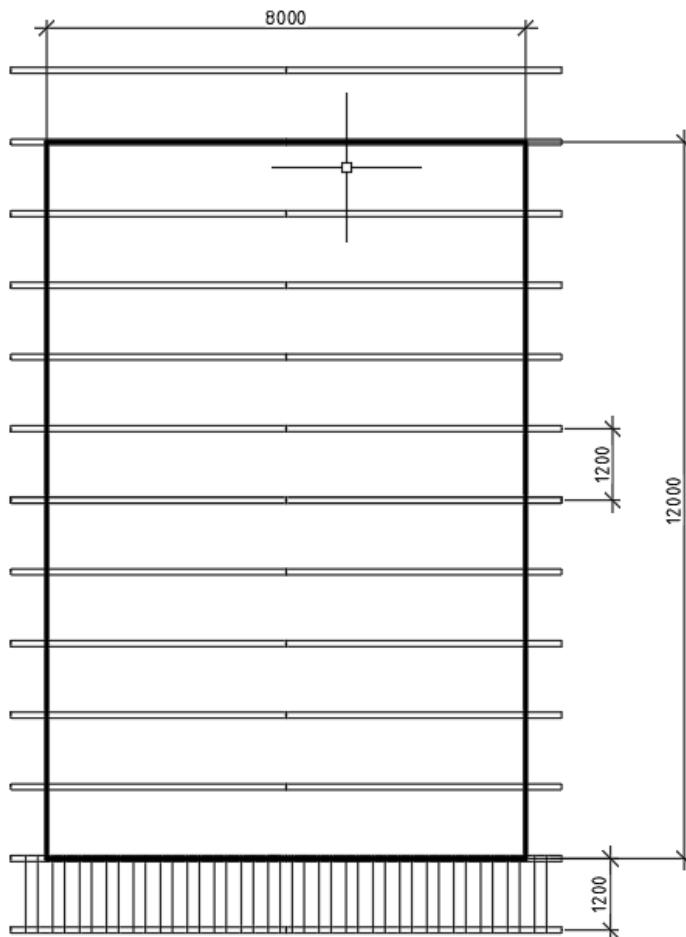
Рис. 5. Чертеж раскладки стропил
