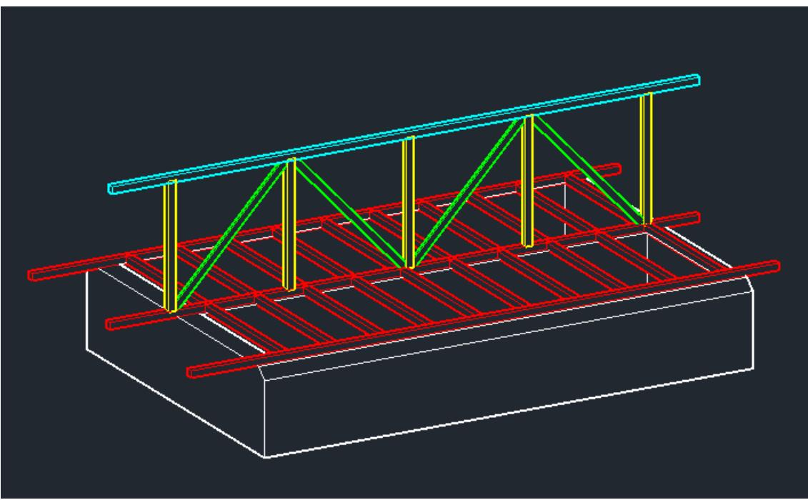
Рис. 8. Создание связевых вертикальных элементов кровли
