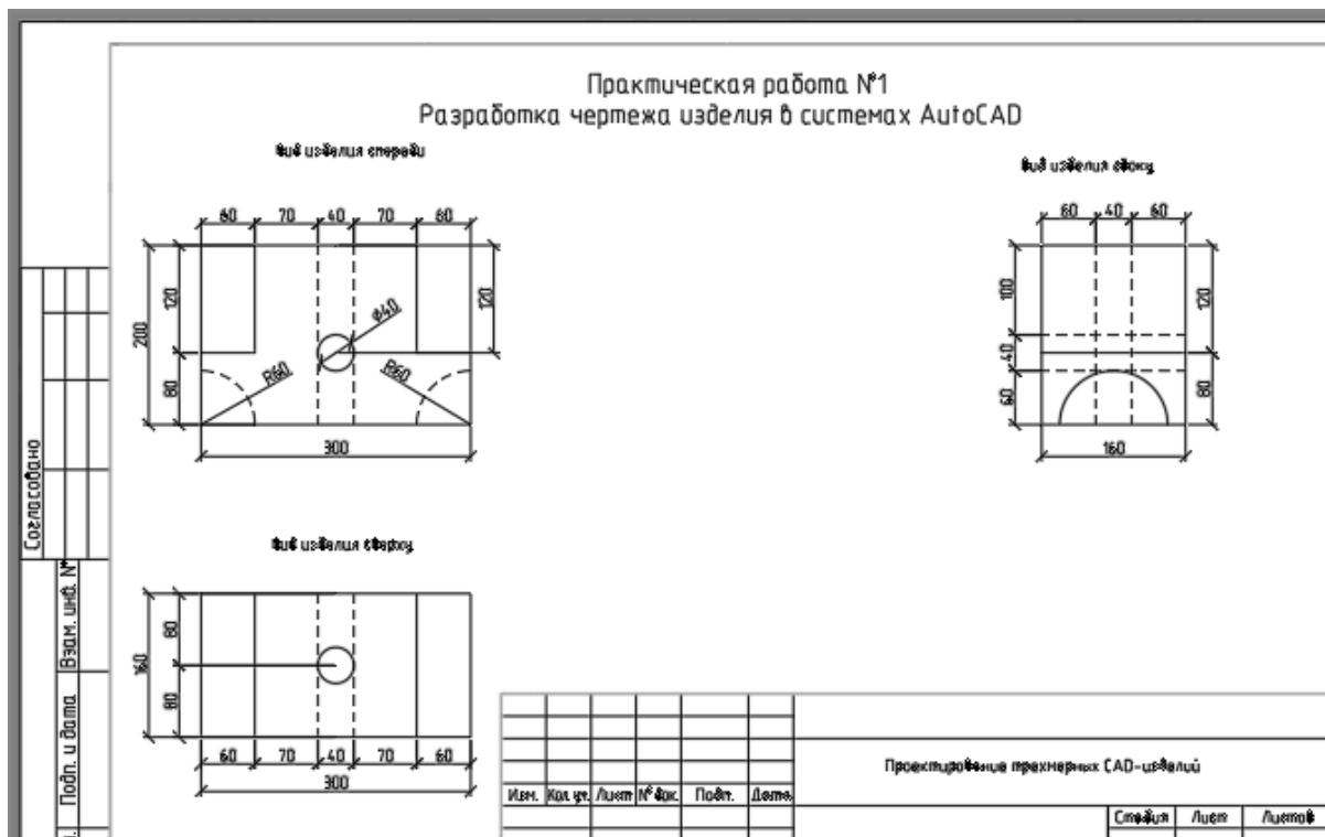
Рис. 4. Формирование чертежа модели в 2D формате в соответствии с требованиями ЕСКД
