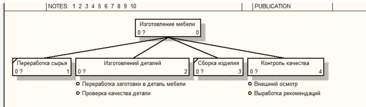
Рисунок 7 - Дерево узлов с ортогональными линиями.
