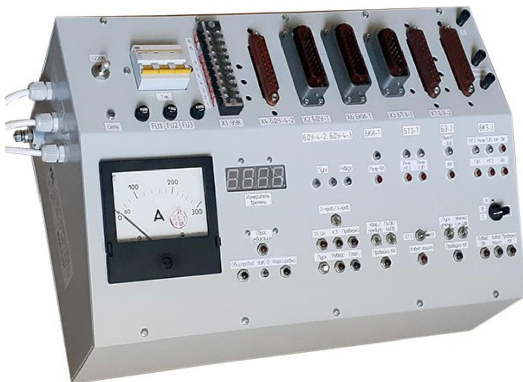
Рисунок 12 - Стенд контроля блока контроля изоляции (БКИ)
