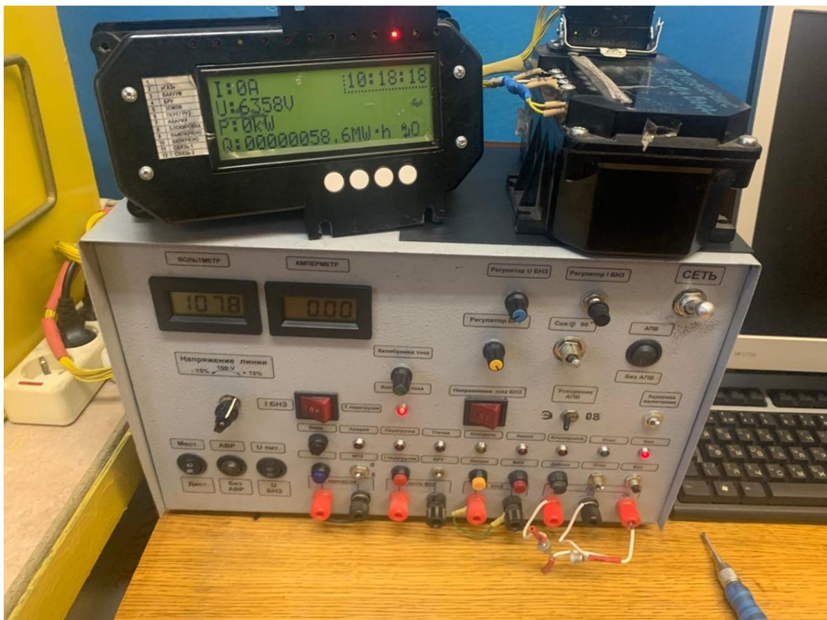
Рисунок 11 - Испытательный стенд БЗУ-2-НЛ для проверки блока БЗУ-2-05-О
