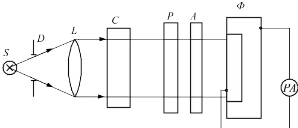
Рис. 6.3. Установка для анализа частично поляризованного света
