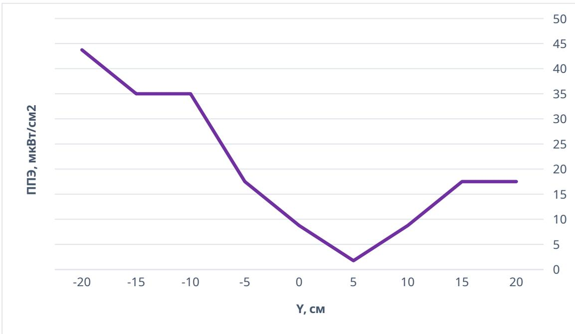
Рисунок 2 - график зависимости ППЭ от расстояния от источника излучения в координатах (ППЭ, (мкВт/см<sup>2</sup>); Y, (см))
