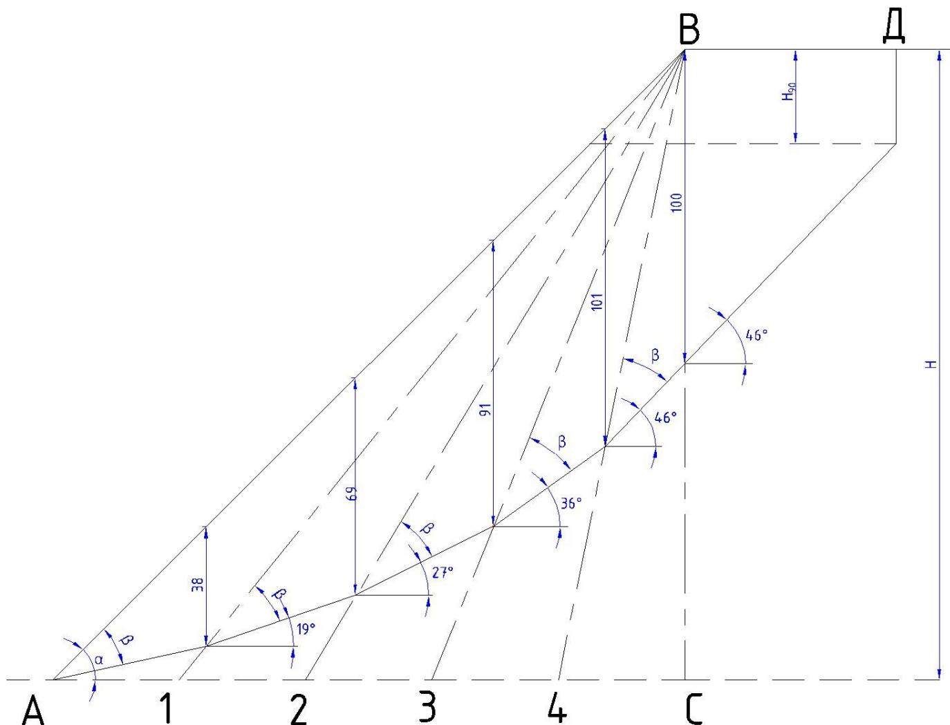
Рисунок 1 - Схема для определения зоны скольжения горных пород
