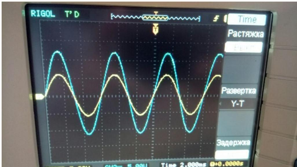
Рис. 6 – Осциллограмма работы инвертирующего усилителя.
