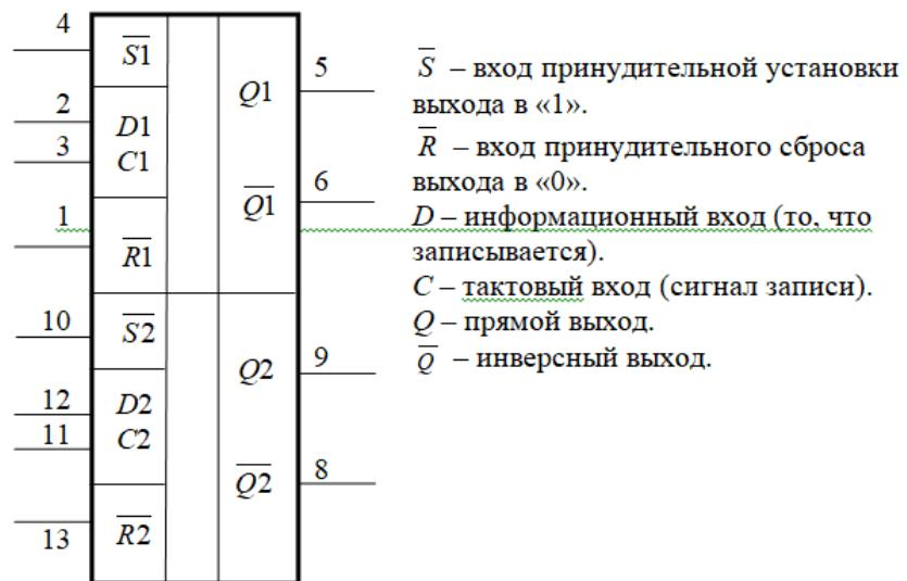
Рис. 1.8. УГО микросхемы 1533ТМ2 и сборка сдвоенного D-триггера.
