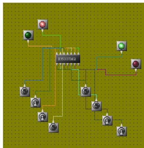
Рис. 1.9. Сборка сдвоенного D-триггера (скриншот).
