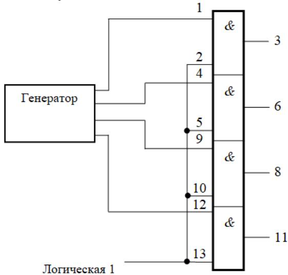
Рис. 1.4. Коммутация выходных сигналов генератора, сдвинутых по фазе относительно друг друга, к входам 1533ЛИ1.
