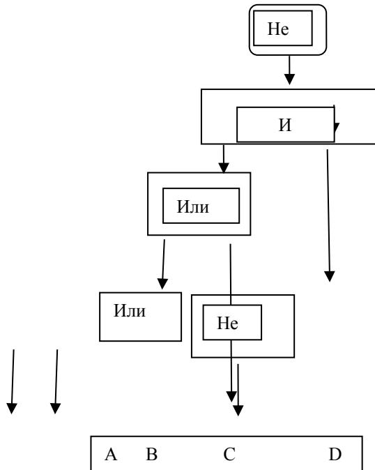
На базе микросхем 1533ЛИ1 (4\*2И) и 1533ЛЛ1 (4\*2ИЛИ) построить вентили 5И и 5ИЛИ, «собрать» и продемонстрировать их работу. Составленные схемы и скриншоты собранных вентилей занести в отчет.
