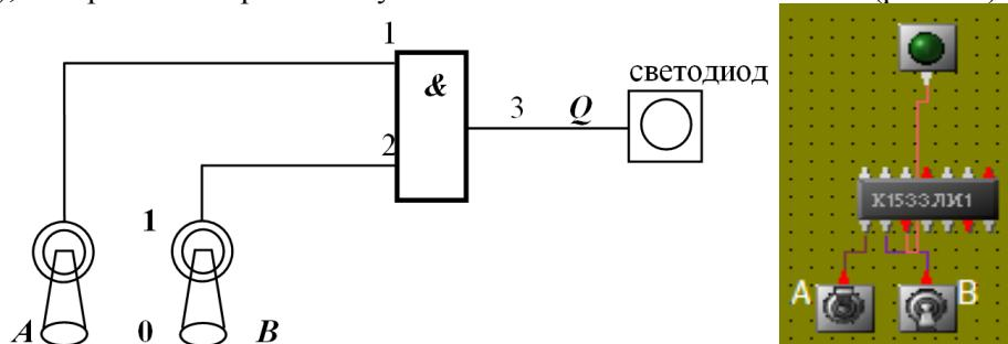
Рис.1.1. Схема включения логического элемента И (пример).
