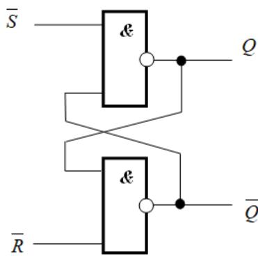
Рис. 1.5. Схема RS-триггера.
