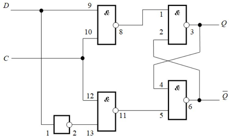
Рис. 1.6. Схема синхронного D-триггера.
