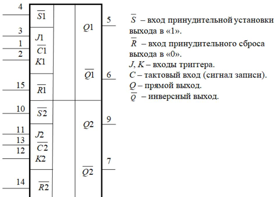
Рис. 1.11. УГО микросхемы 1531ТВ9.
