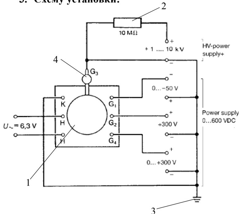
1 – Электронно-дифракционная Трубка с креплением
